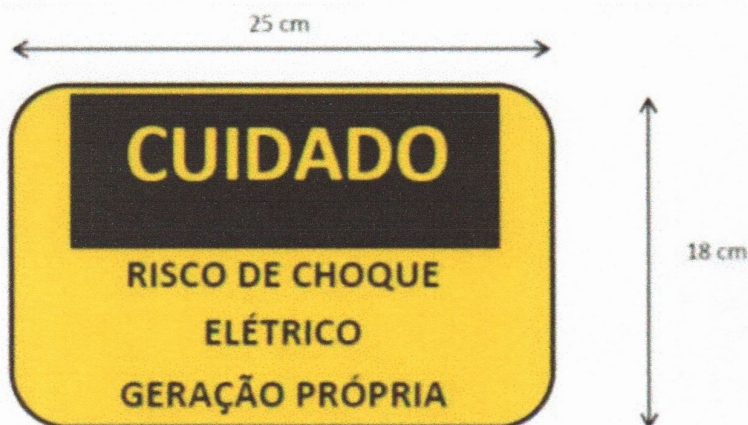
Figura 03 – Placa de advertência e sinalização de Geração Própria.
